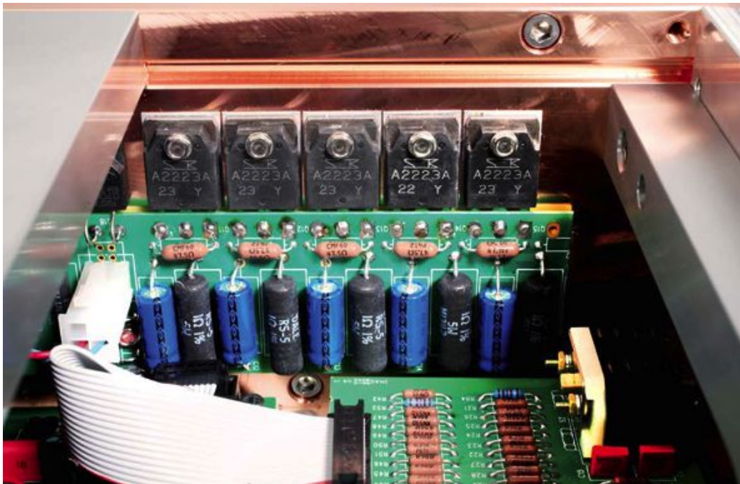
Eine Brücken-Endstufe aus hoch selektierten Sanken-Leistungstransistoren hängt an den Ausgangspolklemmen (oben). Die aus einem vollen Alublock gefertigte Gerätebasis enthält die Netztrafos, der auffällig flach bauende Riesen-Ringkern der Ausgangsstufen läuft erstaunlich leise (unten).
